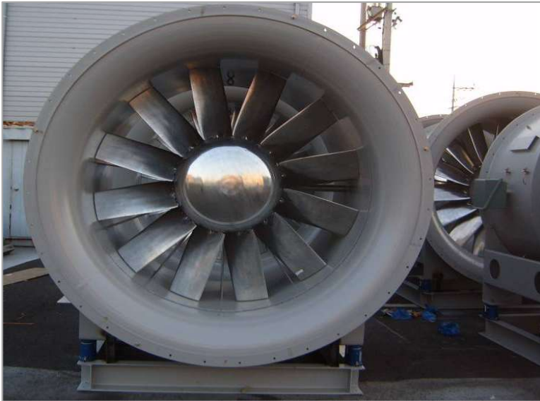
지하철 본선 축류송풍기
