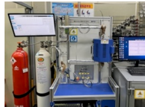
촉매 기반 연료 개질 및 off-gas 후처리 반응 실험
