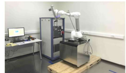
전기적 빠른 과도현상 및 버스트 시험
